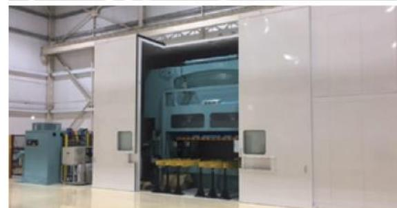
写真上: フリント新工場 写真下: 渡ヶ島工場 モータコア用高速プレス
